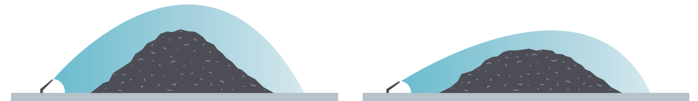
Ajustes variables del ángulo de trayectoria del chorro, para poder adaptarse a la configuración de las escombreras. Diferentes ajustes de ângulo de trajetória para adequar o perfil do jato às configurações das pilhas de materiais.
