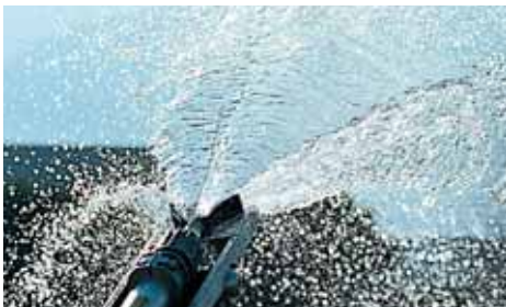
Chorro rociado en fase de arranque del cañón Jato espalhado no início de operação
